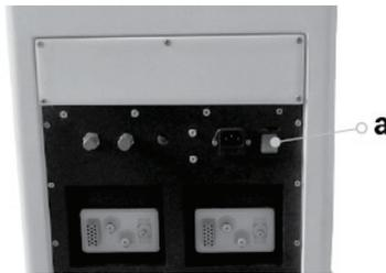
b) **Llave de contacto:** Se utiliza para encender y apagar la fuente de alimentación. (En sentido horario para encender y hacia la izquierda para apagar).
